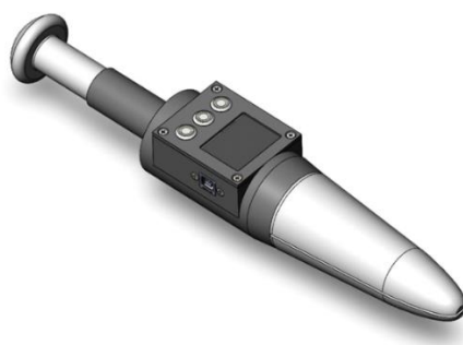
Рисунок 1 – 3D модель тензометрического анального дилататора
